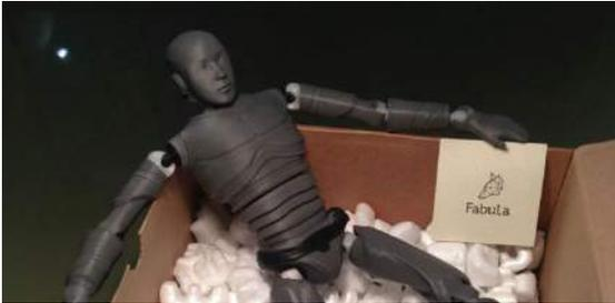
Il Robot è realizzato in parti, successivamente assemblate e con inserti snodabili . Ogni elemento è stato realizzato utilizzando la stampa 3d.
